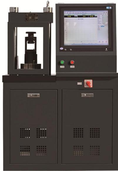
**产品简介：**水泥恒应力压力试验机是适用于水泥砂浆抗压强度试验以及混凝土抗折试验。使用前务必仔细阅读说明书。加荷速度 0.3--10KN 可调。输入不同速度自动按标准计算试验结果。标准速度 2.4KN/秒，或 5.0KN/秒。具有微机显示计算储存功能打印数据报告。大大降低了故障率。采用进口比例阀，稳定性高，加荷速度平稳。没有手动送油阀回油阀，真正的全自动恒应力压力机。WINDDOWS 版操作软件简单易用，十分钟学会。软件免费升级，可随时从网上下载新版本。由上海荣计达仪器科技有限公司提供，设备质保期一年，一年内产品如有质量问题，供方负责免费维修。如果因操作不当或者人为损坏，我公司亦应提供维修、更换服务，由此产生的费用我公司会酌情收取。
